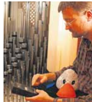
Albert Nass ist Spezialist für Intonation. Paula darf zuschauen, wie er die Tonhöhe der einzelnen Pfeifen der Orgel überprüft und korrigiert, wenn das nötig ist.
